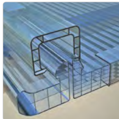
DETALIU START. Profil de start, profil de îmbinare, placă și profile de închidere celule.
